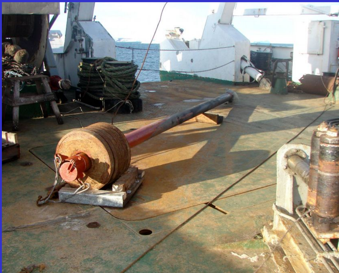
Прямоточная трубка на борту
