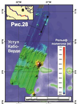
**Рис. 27.** Район юго-восточного обрамления котловины Зеленого Мыса и сочленения уступа Кабо-Верде с цепочкой гор Батиметристов, оттененный рельеф многолучевого эхолота и положение фрагментов сейсмических разрезов 23-го рейса НИС «Академик Николай Страхов» (ГИН РАН, 2006) (Сколовин и др., 2007).
