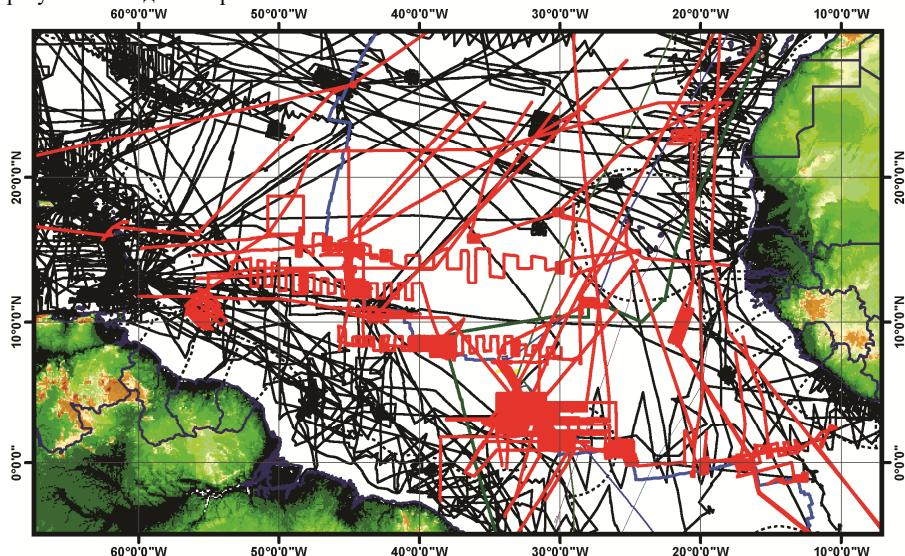
**Рис.1.** Схема изученности экваториального сегмента Атлантики полигонными и маршрутными геофизическими промерами (только сейсмика и сейсмоакустика) по данным открытого доступа (GEODAS, 2010) – черные линии, и данным Геологического института РАН на НИС «Академик Николай Страхов» – красные линии.
