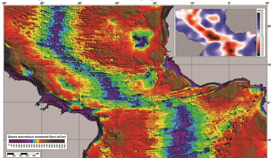
**Рис.15.** Мантийные аномалии Буге в ЭСА и его обрамлении. На врезке показан срез сейсмотомографической модели SL2013sv (Schaeffer, Lebedev, 2013) вариаций скоростей S-волн на глубине 75 км.
