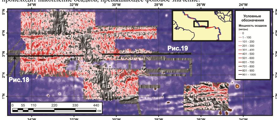
**Рис.17.** Карта мощности осадков южного сегмента ЭСА в пределах зоны САХ и восточной части полиразломной системы Сан-Паулу по данным НСП, выполненного в 7, 11 и 12 рейсах НИС «Академик Николай Страхов» (ГИН АН СССР, 1988-1991, начальники рейсов – Удинцев Г.Б.) (Efimov et al., 1996; Мазарович и др., 2001). Жирными линиями показаны положения фрагментов разрезов и подписаны соответствующие им номера рисунков.
