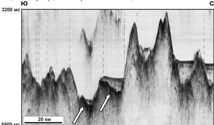
Рис.20. Профиль S07-SP-20. 7-й рейс НИС «Академик Николай Страхов» (ГИН АН СССР, 1988) вкрест восточных пассивных частей полиразломной системы Сан-Паулу. Стрелками указаны аномалии типа «яркое пятно» в выровненной кровле фундамента.
