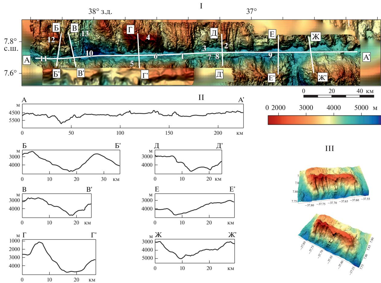
**Рис. 3.** Рельеф дна в районе разломной зоны Вернадского по данным 45-го рейса НИС “Академик Николай Страхов”. I – батиметрическая карта; II – батиметрические профили: А–А’ (продольные); Б–Б’, В–В’, Г–Г’, Д–Д’, Е–Е’, Ж–Ж’ (поперечные); III – гора Пейве (3D модель рельефа).
