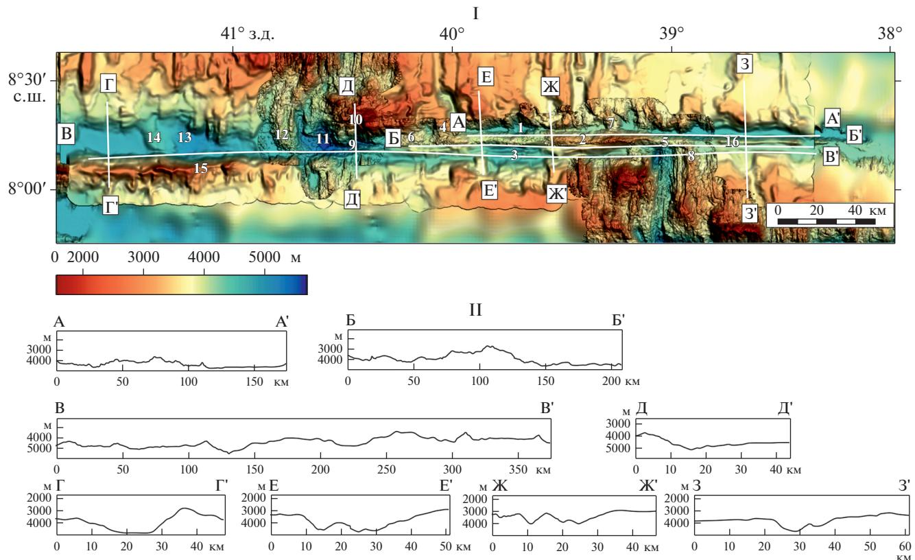
**Рис. 2.** Рельеф дна в районе разломной зоны Долдрамз по данным 45-го рейса НИС “Академик Николай Страхов”. I – батиметрическая карта; II – батиметрические профили: А–А', Б–Б', В–В' (продольные); Г–Г', Д–Д', Е–Е', Ж–Ж', 3–3' (поперечные).
