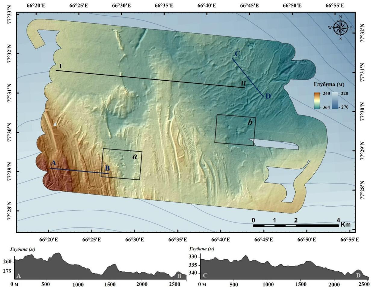
Рис.4. Цифровая модель рельефа дна полигона №2. АВ, CD – батиметрические профили, I-II – сейсмоакустический разрез, а, б, с – участки распространения покмарок, см. рис. 5 (подложка - GEBCO-2020, <https://www.gebco.net> с изобатами, проведенными через 10 м)
