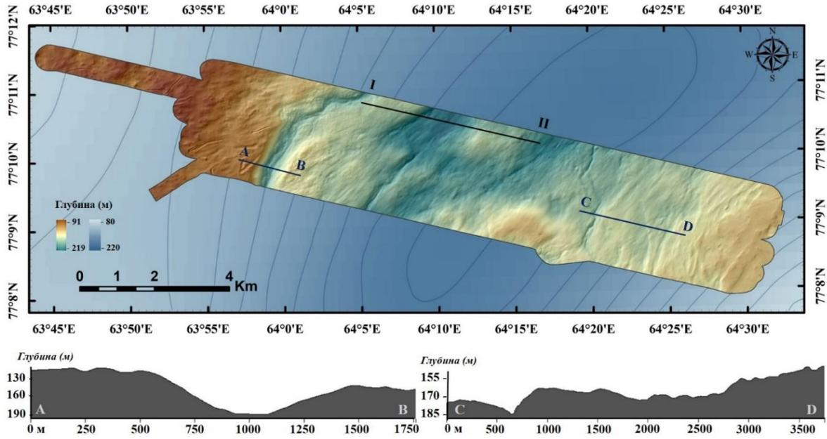
Рис. 2 Цифровая модель рельефа дна полигона №1. АВ, CD – батиметрические профили, I-II – сейсмоакустический разрез (подложка - GEBCO-2020, <https://www.gebco.net> с изобатами, проведенными через 10 м)
