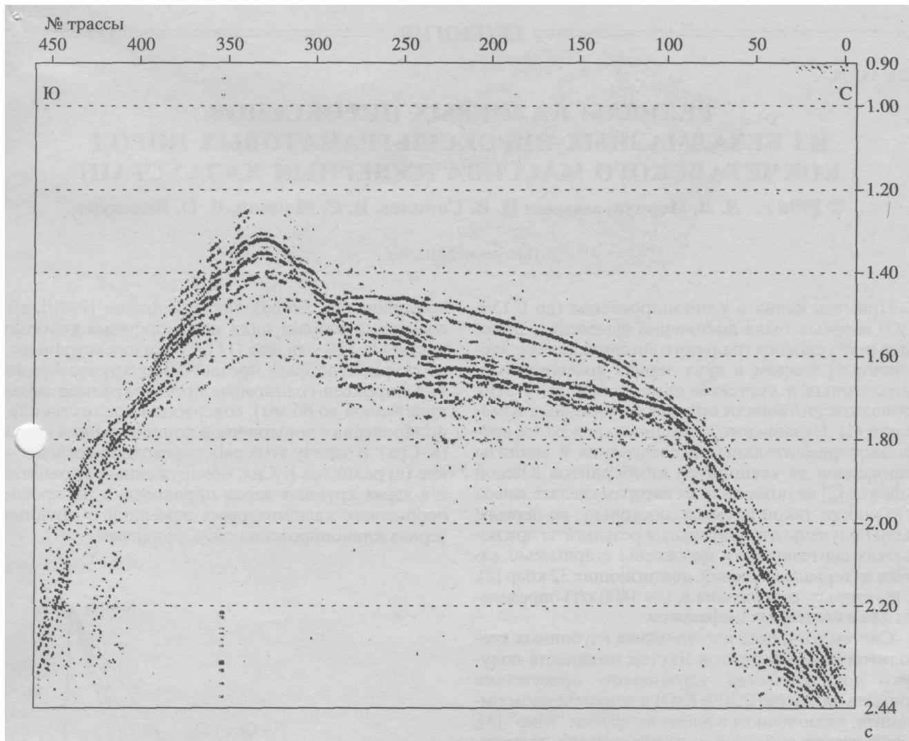
Рис. 3. Сейсмический профиль 4. Метод обработки – деконволюция по Винеру в полосе частот 15–100 Гц.
