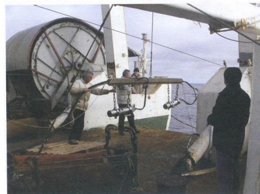
Сгруппированные пневмоизлучатели для многоканального сейсмического профилирования. Фото С.Ю. Колдажского (Геологический институт РАН), 2006 г.
