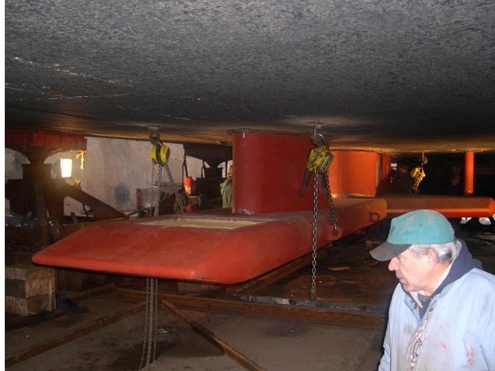
Рис. 4. Гондола, несущая зaborное акустическое оборудование.
