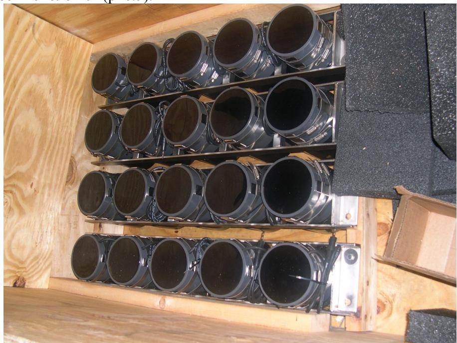
Рис. 5. Основная часть приемно-излучающей матрицы датчиков 5x5.
