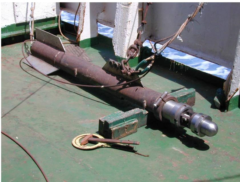
Рис. 9. Пневмоситочник сейсмических волн, собранный на базе буксируемого стабилизатора (Фото - Соколов С.Ю., 2000)
