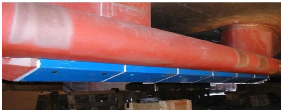
Рис. 2.1.3. Передающие модули глубоководного эхолота 8150
