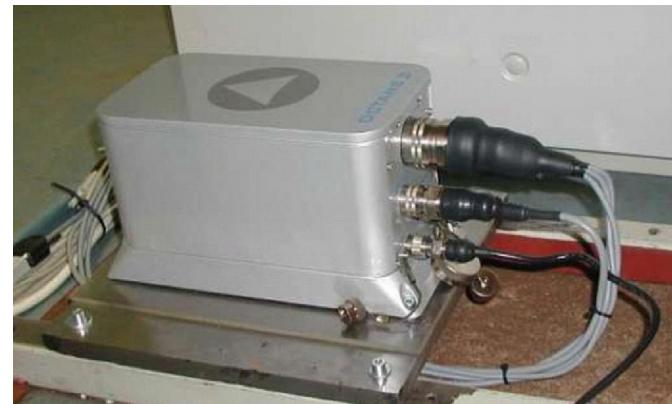
Рис. 2.1.6 Сенсоры движения и гирокомпас, объединенные в приборе OCTANS.
