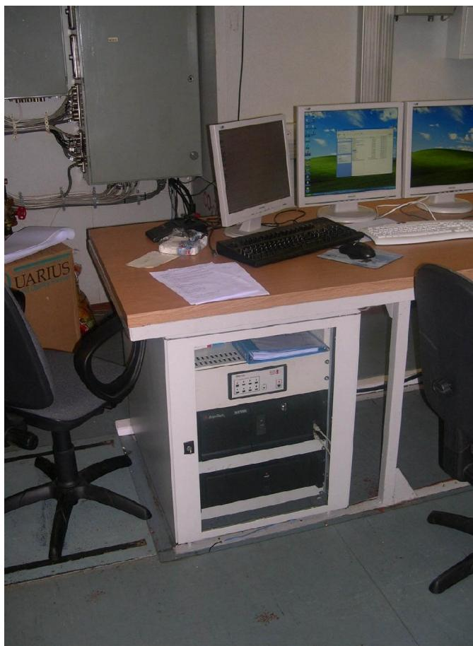
Рис. 2.3.3. Рабочая стойка с управляющим компьютером и силовой частью EdgeTech 3300. Рядом справа – дисплейный массив SeaBat 8111/8150/7111/7150. (Фото - Соколов С.Ю., 2005)
