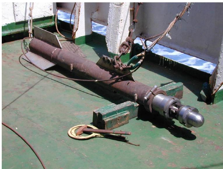
Рис. 2.2.1. Пневмоситоник сейсмических волн, собранный на базе буксируемого стабилизатора (Фото - Соколов С.Ю., 2000)
